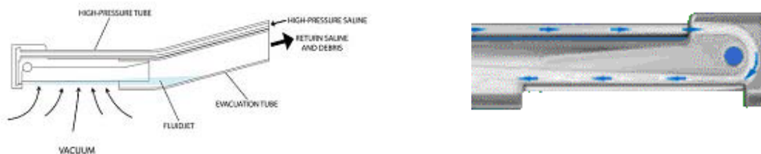
Flusso dell'acqua all'interno del gruppo pistola monouso
